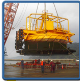
一点係留ブイ/SBM (シングル・ブイ・モアリング*) *Single Buoy Mooring
